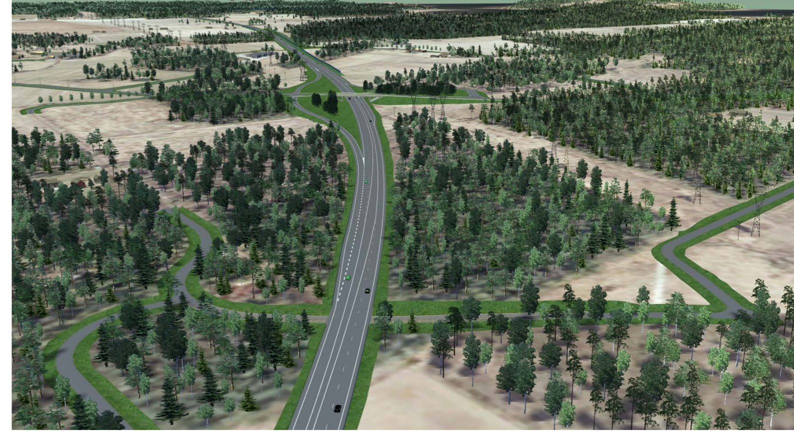
Kuva 4.8. Valtatie parannetaan keskikaiteelliseksi ohituskaistatieksi Jokuen ja Tillolan välillä uuteen maastokäytävään Kausalan pohjoispuolelle. Katkeavat yhteydet korvataan risteysilloilla ja tiejärjestelyillä. Havainnekuva Kausalan eritasoliittymästä Lahden suuntaan.
