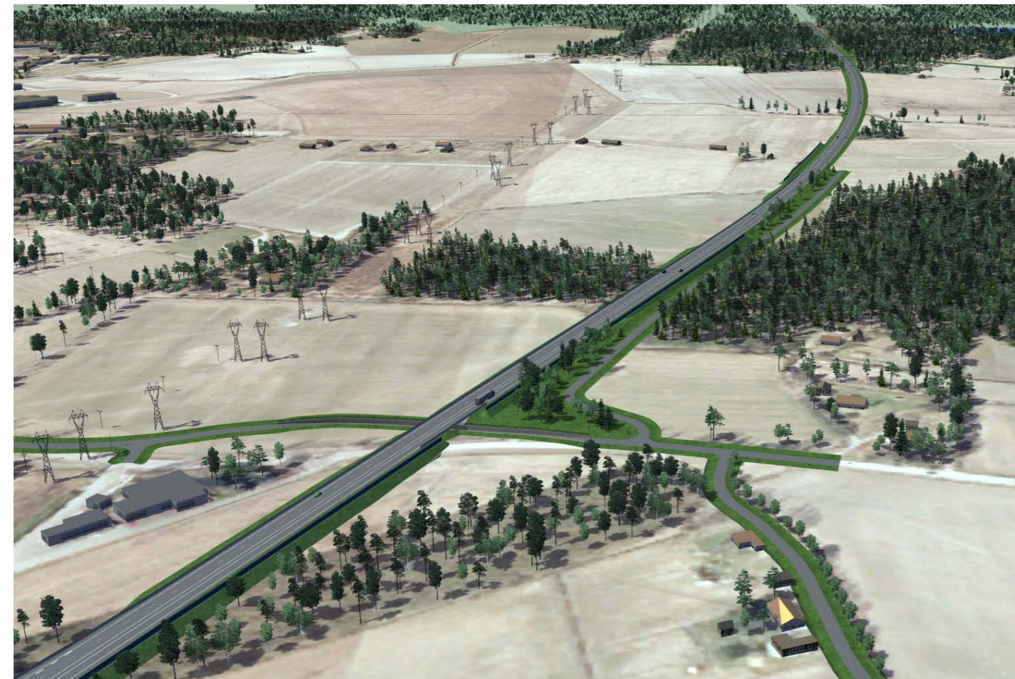
Kuva 5.6. Valtatie parannetaan uuteen maastokäytävään ja sen alle jää pelto- ja metsäalueita. Tilusjärjestelyillä vaikutuksia pyritään lieventämään. Kulkuyhteydet turvataan tiejärjestelyillä ja risteyssilloilla. Havainnekuva nykyiseltä litintieltä Lahden suuntaan.
