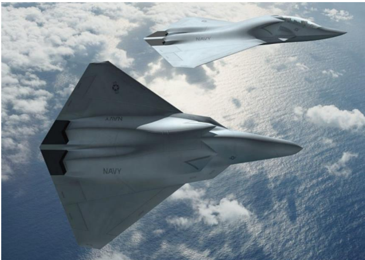
Kuva 2. Näkemys 6. sukupolven ilmataistelukoneen pyrstöttömästä konfiguraatiosta [14]
