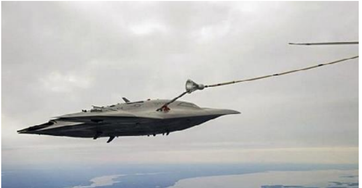
Kuva 5. Northrop Grumman X-47B suorittamassa ilmatankkausta [37]
