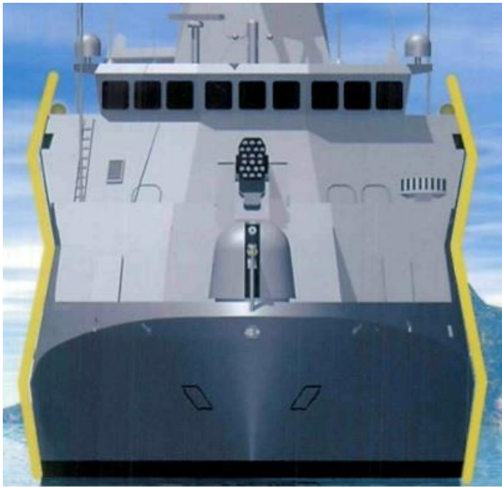
Kuva 8. Braunschweig -luokan korvetin kyljen "X shape" -muotoilu tutkapoikkipinta-alan pienentämiseksi [54]
