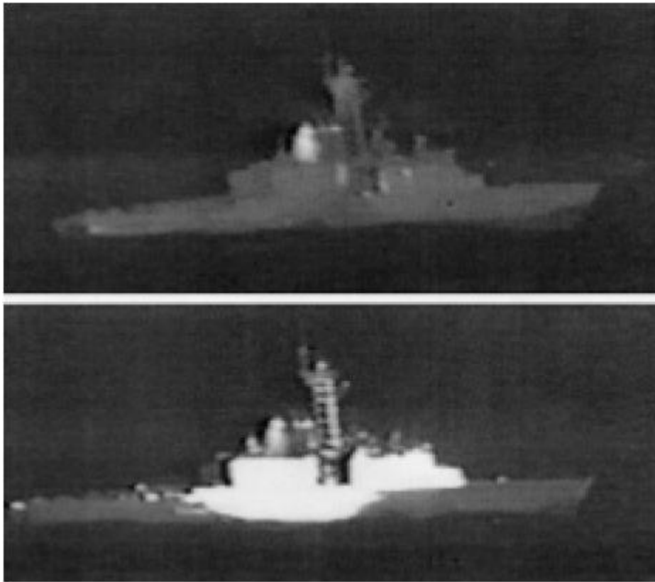
Kuva 4. Auringon säteilyn heijastuminen infrapuna-alueella sota-aluksen kyljestä [37, s. 3]
