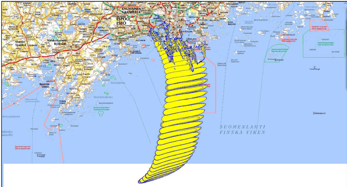
Kuva 4. Peruspisteestä 3 alkava 30 000 tonnin raakaöljyvahinko vuoden 2000 trajektorin 7366 mukaan tunnin välein. Vahingon rantautuminen alkaisi noin 30 tunnin kuluttua.
