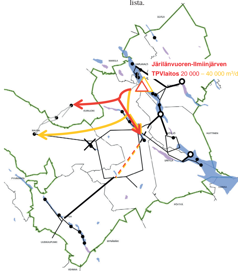
Kuva 6. Suunnittelualan vedenhankinnan toinen vaihe eli siirtyminen tekopohjavesilaitoksen käyttöön.
