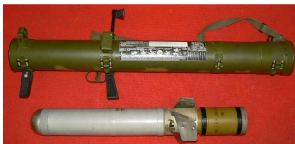
Kuva 7 RPO-A shmel ampumakunnossa termobaarinen raketti vierellään [40]
