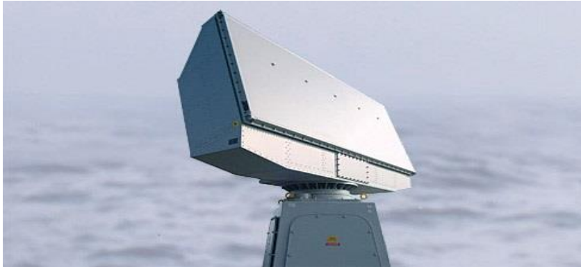
Kuva 6. TRS-3D/16-ES monitoimitutkan antenni [22]
