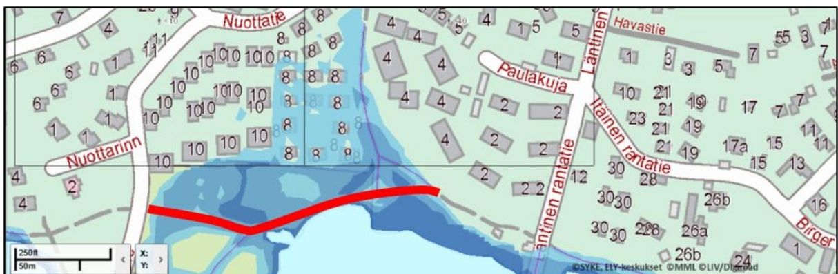
Bild 10.2-3. Den föreslagna höjningen av gång- och cykelleden i södra delen av Notudd.
