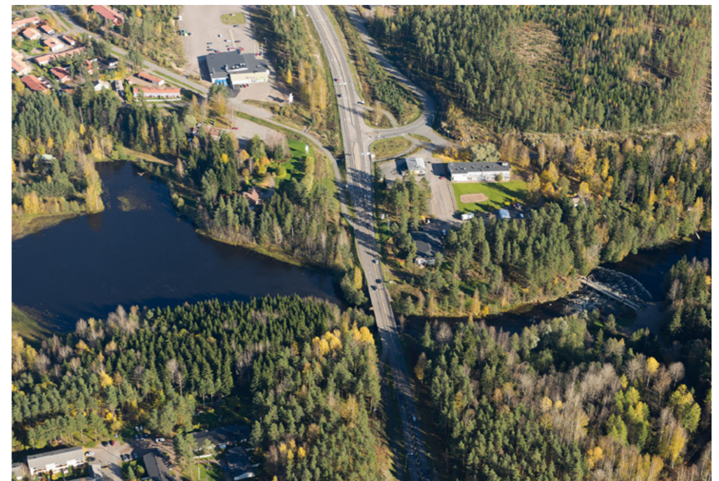
Kuva 2.5. Käyräjoki on merkittävin siltapaikka suunnittelualueella. Nykyinen silta on kapea eikä se kestä raskaita erikoiskuljetuksia.
