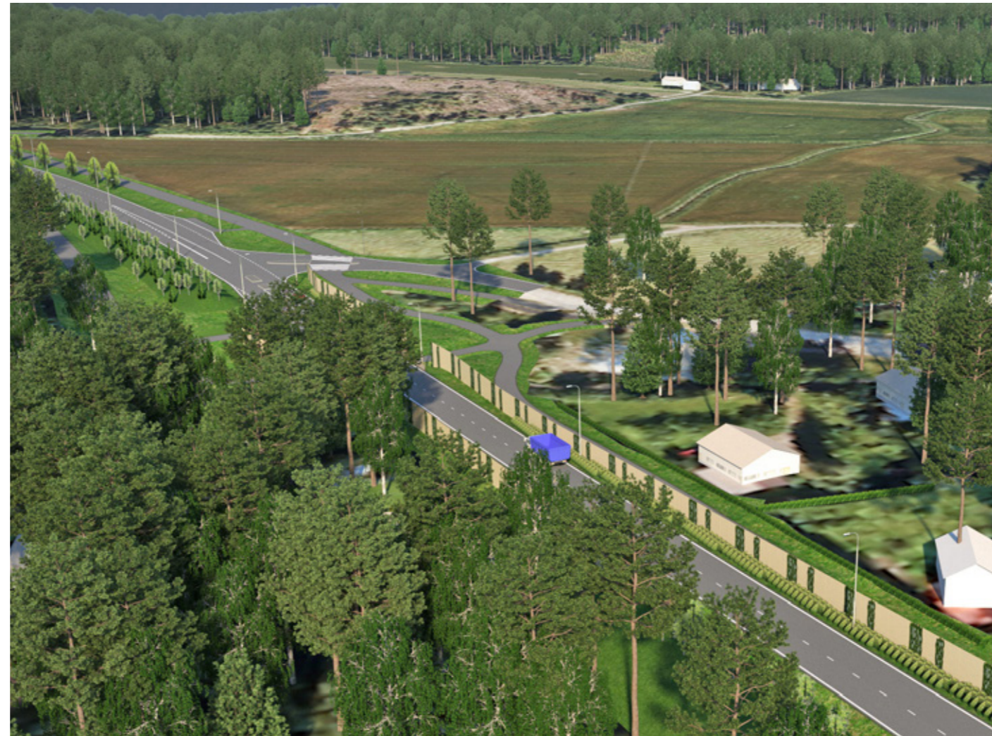
Kuva 4.20. Heparontien liittymän alueelle ehdotetaan alikulkukäytävää ja tehokasta meluntorjuntaa. Havainnekuva Kouvolan suuntaan.
