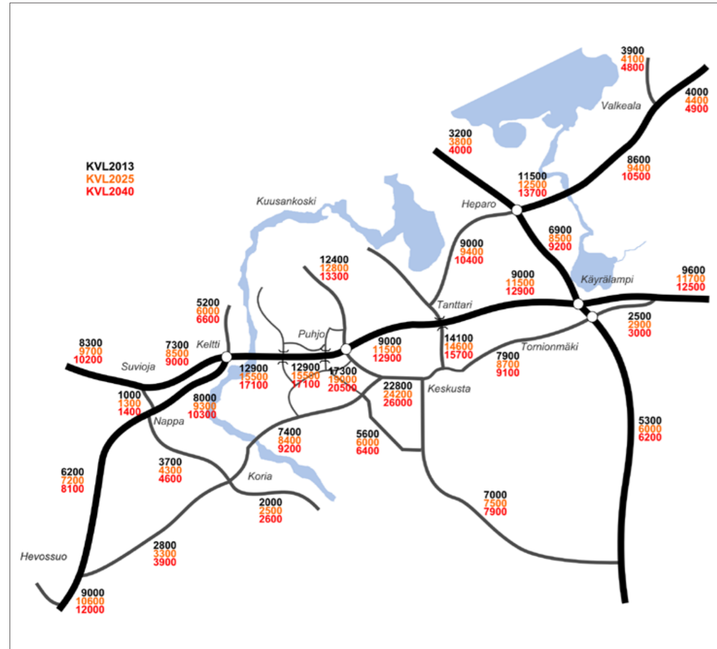
Kuva 2.10. Suunnittelualueen tieverkon nykyiset liikennemäärät sekä liikenne-ennusteet vuosille 2025 ja 2040 liikennemallin mukaan (keskimääräinen vuorokausiliikenne ajoneuvoa vuorokaudessa).
