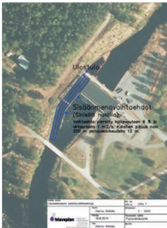
Kuva 24: Lieksankosken voimalaitos, pystyrakokalatie.
