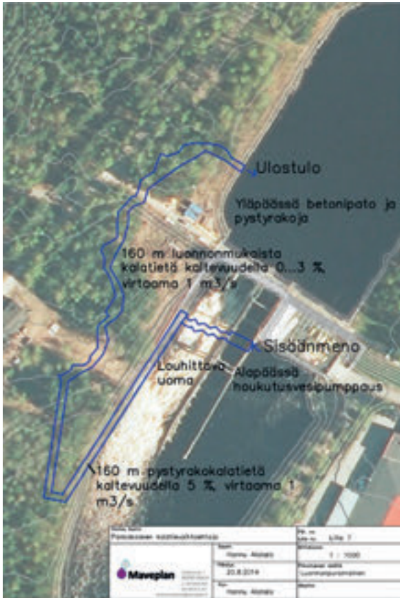
Kuva 31: Pankakosken voimalaitos, luonnonmukaisen ja pystyrakokalatien yhdistelmä.
