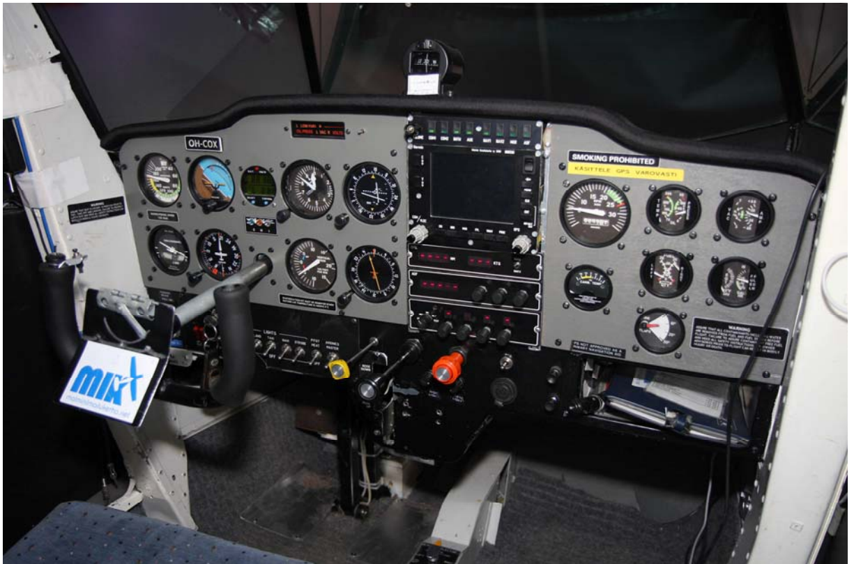
Kuva 3. Malmin Ilmailukerhon harrasterakenteinen Cessna 172 -simulaattori. Laitteisto käyttää Microsoft Flight Simulator 2004 -ohjelmistoa, aidonnäköisen mittariston ollessa servotoiminen.
