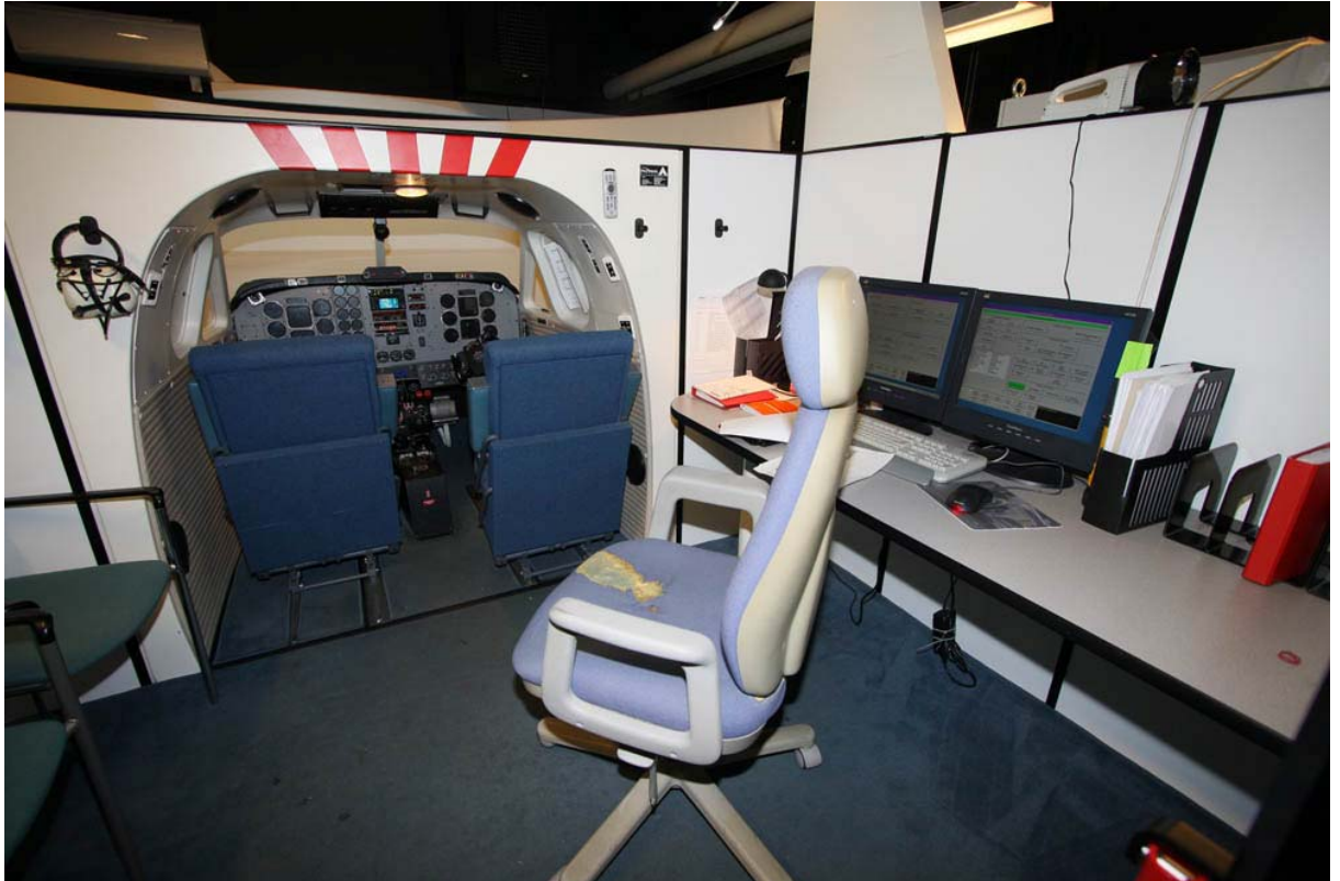
Kuva 2. Patria Pilot Training Malmin simulaattorikokonaisuus. Myöhempää koulutusvaihetta varten suunniteltua laitetta käytetään PPL-koulutuksessa perusmittarilentämisen harjoitteluun ja siitä voidaan lukea hyväksi viisi lentotuntia.
