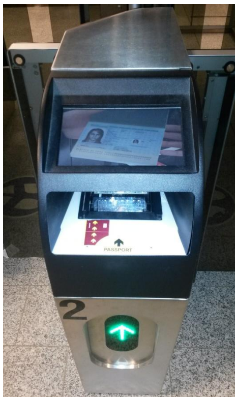
Kuva 5. Automatisoidun rajatarkastusautomaatin passinlukija
