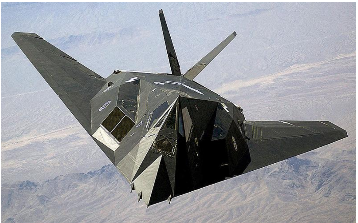
Kuva 3: F-117 Nighthawkin muotoilussa on pyritty suosimaan suoria linjoja poistamalla perinteiset kurvit koneen muotoilussa. 25
