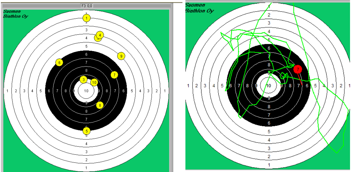
KUVIO 2. RK-pystyammunnan osumien hajontakuviota ja aseiden heiluntakuviota reserviläisellä, joka punnersi 61 toistoa/min etunojapunnerrusmittauksessa.
