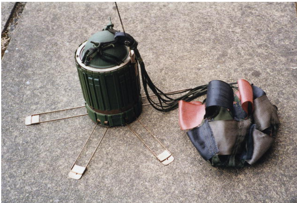
Kuva 9. AT2 panssari miina kääntyy maahan pudottuaan oikein päin oikaisuvarsien avulla [24]
