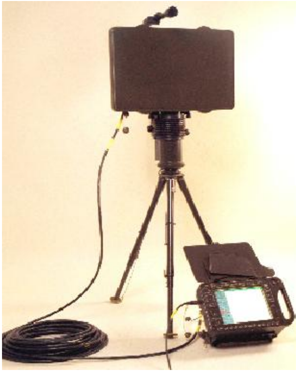
Kuva 3. Maastonvalvontatutkan pääosat: Käyttöyksikkö, tutka, jalusta, pyörityskoneisto, tähtäin, kuulokkeet ja kaapelit [15]
