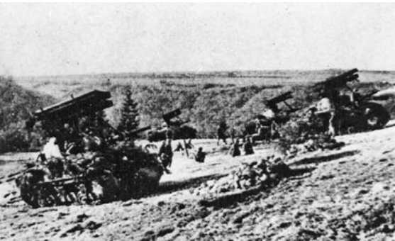
Kuva 18. Sherman-panssarivaunu varustettuna moniputkisella raketinheitimellä. Vaunuja voidaan esim. tulivalmistelun aikana käyttää raketinheitinpatterina vaikeassakin maastossa. Raketinheitinlaitteet ovat irrotettavia.
