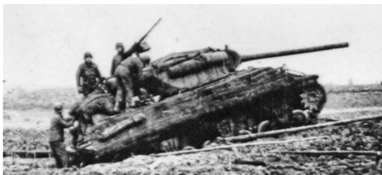
Kuva 1. Amerikkalainen "Tankdestroyer". Kuvassa vaunu on tuliase- massa epäsuoraa-ammuntaa varten. Asema on kaivettu viistoksi put- ken lisäkorotuksen mahdollistuttamiseksi.
