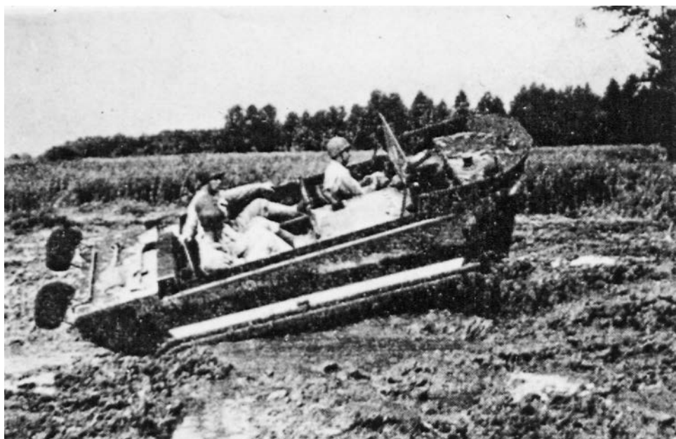
Kuva 11. Maalla ja vedessä liikkuva telaketjuvetoinen moottoriajoneuvo "The Wessel", Cargo Carrier M/29.
