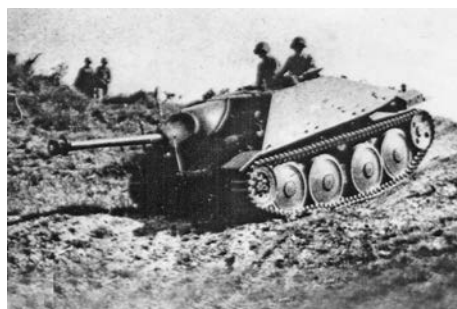
Kuva 3. Sveitsiläinen 75 mm panssarintorjunta- vaunu. Huom. Vaunu vaikuttaa melkoisesti matalammalta kuin edelli- nen.
