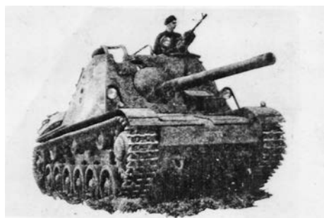
Kuva 2. Ruotsalainen panssarintorjunta- kanuunavaunu. Huom. Vaunu vaikuttaa korkealta ja kiinteä torni on päältä sekä takaa avonainen.
