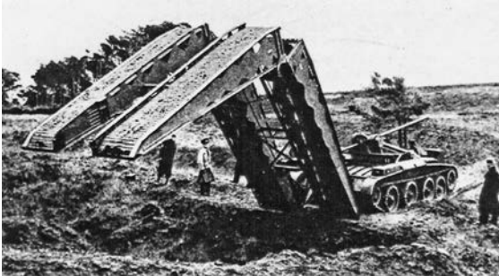
Kuva 16. Siltapanssarivaunu, jonka sillan pituus on n. 10–20 m.
