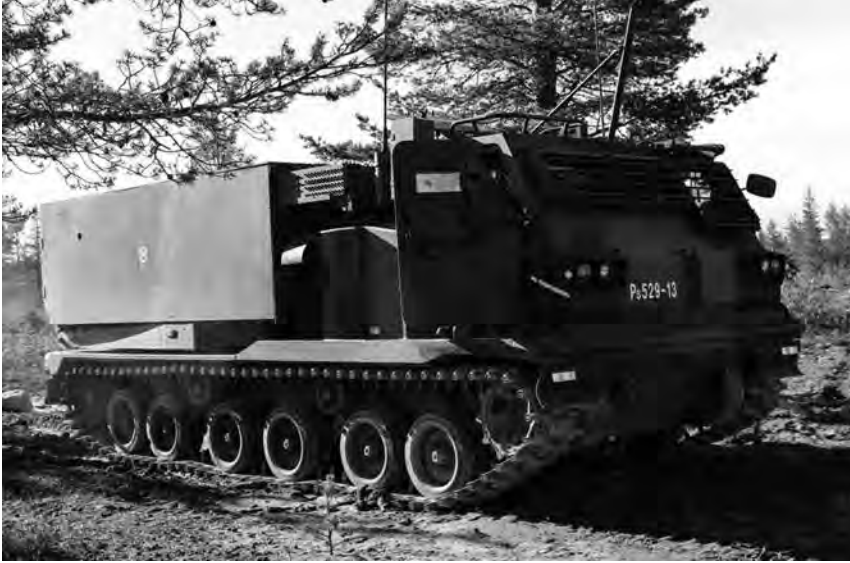
■ Raskaat raketinheitimet hankittiin maanpuolustusalueiden ja sotilasläänien tuliyksiköiksi. Raskas raketinheitin vastasi 2000-luvun taistelukentän haasteita. Kuvassa raskas raketinheitin RS RAKH 06 (MLRS M270) vuonna 2013. Kuva Sotamuseo.
