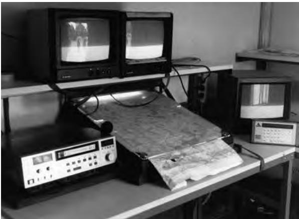
■ Valonvahvistinten, laseretäisyysmittarien ja videokameroiden yleistyttyä ulkomailla 1980-luvun alkupuolella Suomessa ryhdyttiin tutkimaan ja kehittämään kaukotähystykseen perustuvaa maaltiedustelua. Kuvissa kaukotähystysjärjestelmän laitteita 1990-luvulla. Kuvat Sotamuseo.
