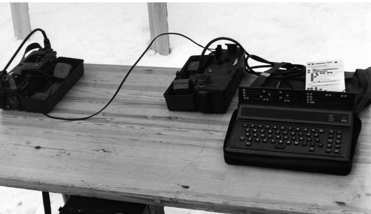
■ Tulikomentojen vakiointi ja niiden lähettäminen digitaalisessa muodossa toteutettiin kaikessa tulikomentoviestityksessä 1980-luvulta alkaen. Kuvassa sanomalaite ja P-78-puhelin. Kuva Sotamuseo.
