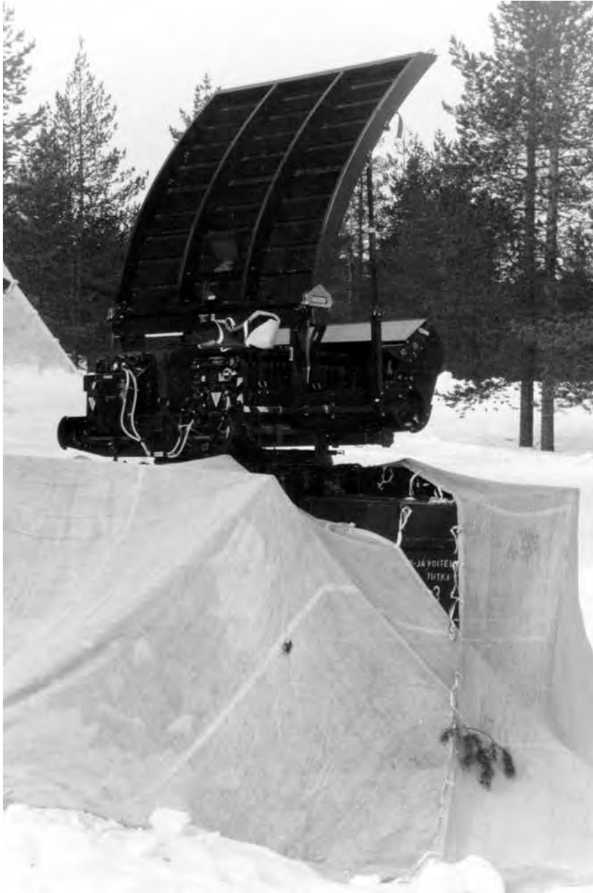
■ Tulenjohto vihollisen selustassa hoidettiin sissi-, piilo- ja kaukotulenjohdolla mukaan luettuna tutkatulenjohto, joka ulottui noin 20 kilometriin. Kuvassa maalinosoitustutka kenttätykistön talvileirillä vuonna 1990. Kuva Sotamuseo.
