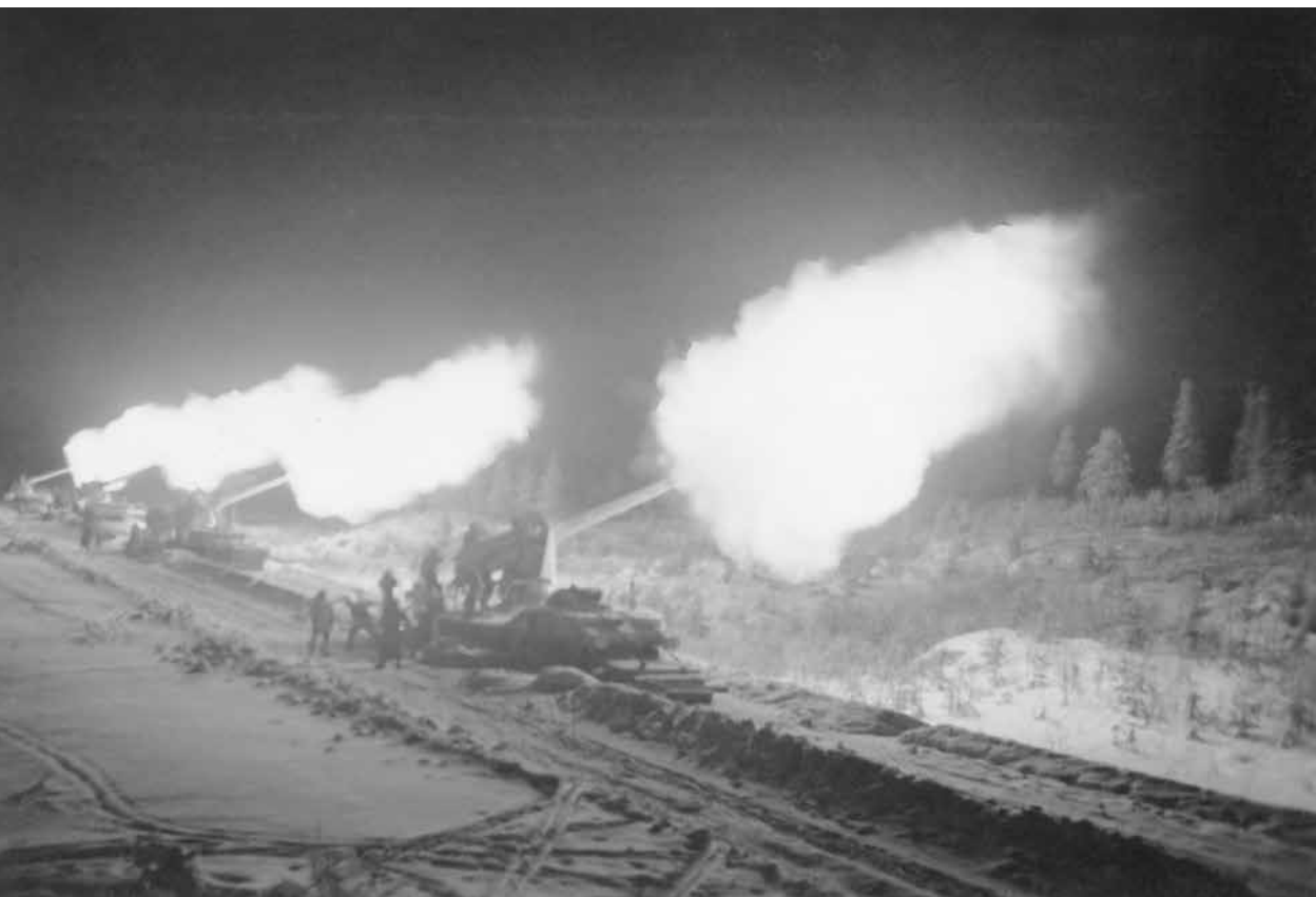
■ Panssarijunia ei pidä sekoittaa rautatietykkeihin, joita niitäkin oli muutamia ylijohdon käytössä jatkosodassa. Kuvassa rautatiepatteri (152/45 C) ampuu Itä-Karjalassa. Kuva Sotamuseo.
