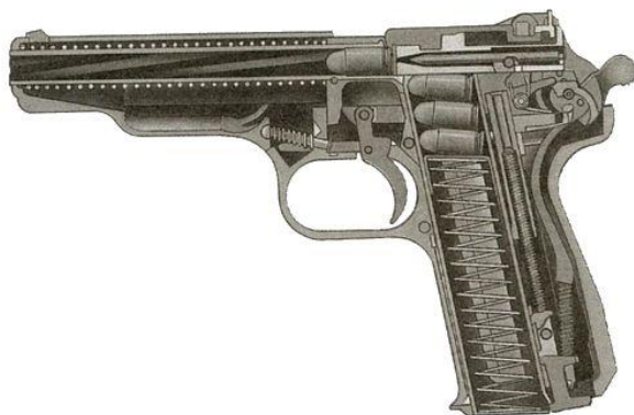
Kuva 5. Stechkin APS poikkileikkaus [19]
