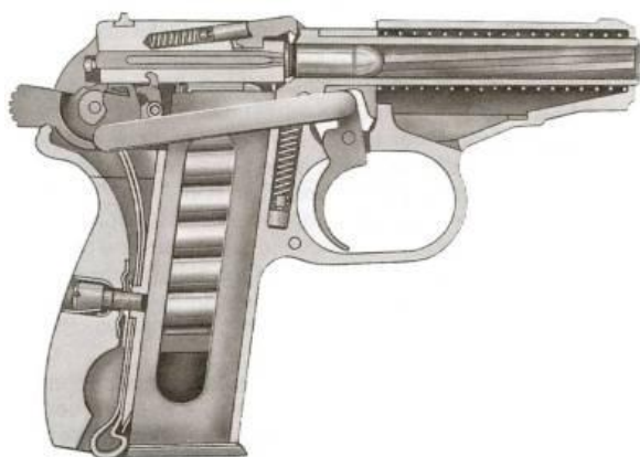
Kuva 3. Makarov PM poikkileikkauskuva [18]
