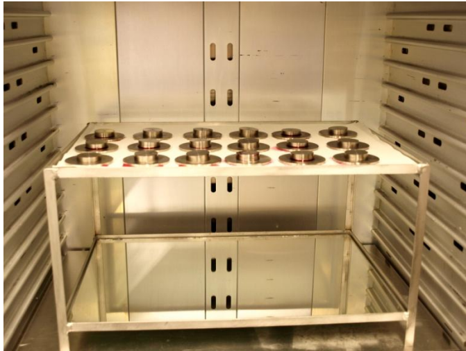
Kuva 2 Kuvassa kehikko on asetettu uuniin ja sen päälle on asetettu 18 näytepalaa, joiden päällä on metallirenkaat.
