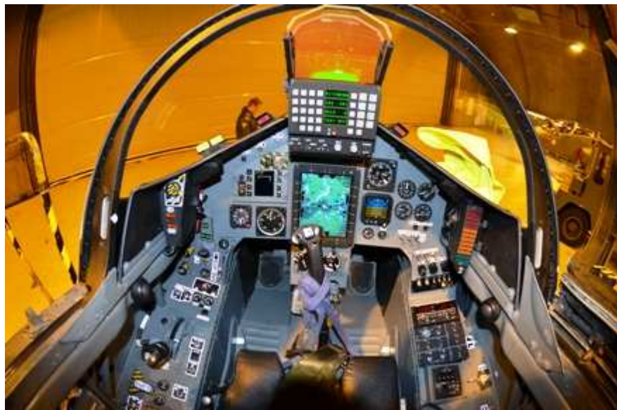
Kuva 5: Hawkin päivitetty ohjaamo (Mk66). 58
