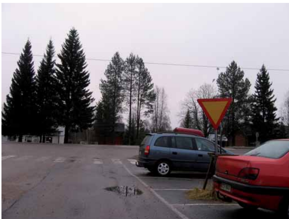
Kuva 20. Koulukeskukselle menevän tien varteen pysäköidyt autot muodostavan näkemäesteen suojatielle. Lisäksi kolmio on kaukana liittymäalueesta.
