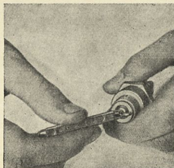
Kuva 8. Sytytystulppien kipinävälin säätö.
