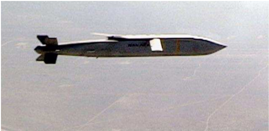
Kuva 7. AGM-154 JSOW liidossa. Kuvasta erottuvat selvästi kuusisiipinen peräsinosa sekä ylärungosta auenneet pääsiivet. 136
