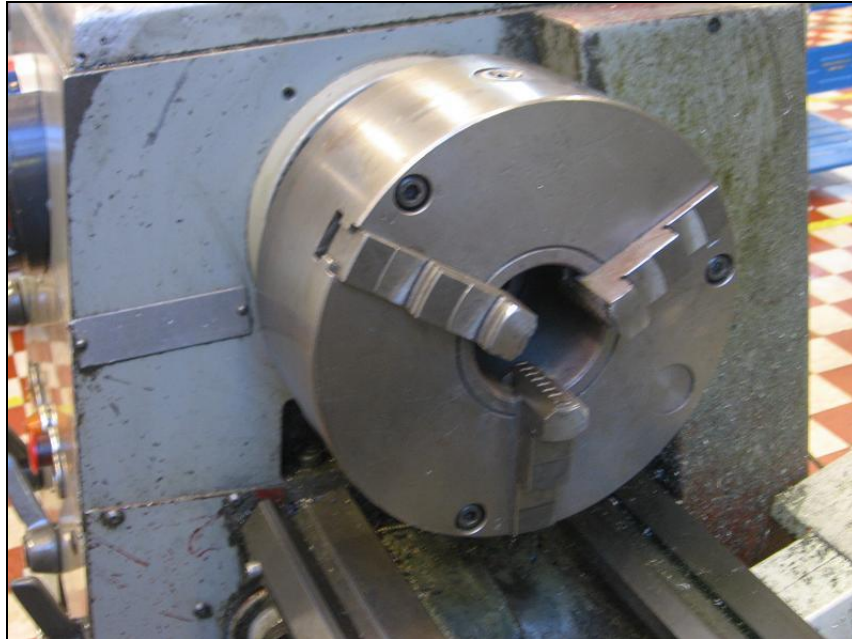
Kuva 3. Kolmileukaistukka, johon työkappale kiinnitetään. Yleisesti on käytössä myös nelileukaistukoita.
