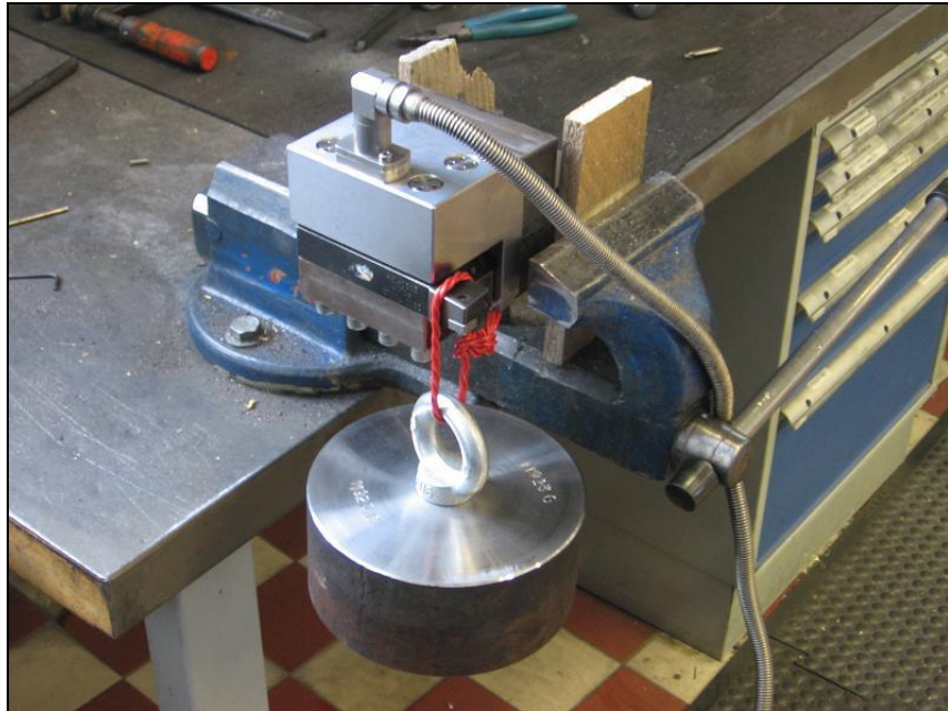
Kuva 11. Anturi kiinnitettynä ruuvipenkkiin ylösalaisin ja punnus roikkuu teränvarressa.
