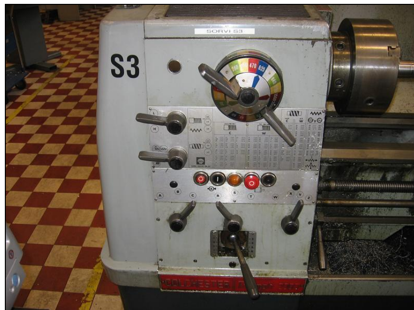
Kuva 2. Colchester-sorvin karapylkkä ja syöttövaihteisto. Hallintolaitteet vaihtelevat malleittain.
