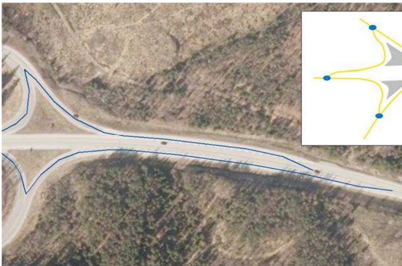
Kuva 11c. Suuntaisliittymä ("kalanpyrstöramppi") Haaraumien yhteydessä olevien kiihdytys-/jarrutuskaistaramppien keskilinjat tehdään kuten muutkin rampit eli keskilinja alkaa kohdasta, josta ramppi maastossa fyysisesti alkaa. Silmukkaramppi: Silmukkarampit tallennetaan kuten muutkin rampit
