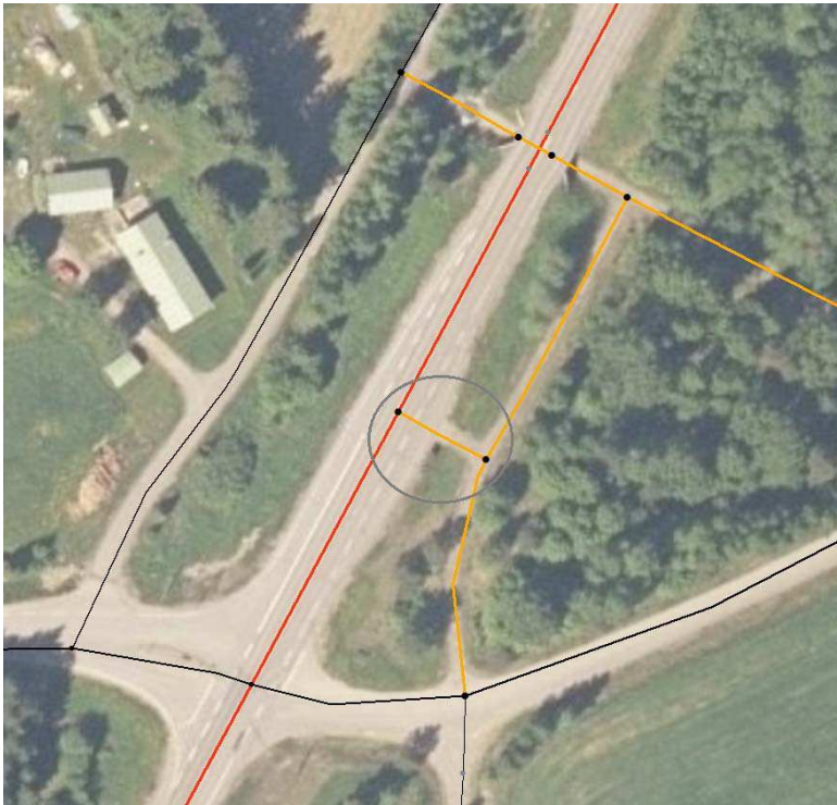
Kuva 25a ja 25b. Kevarin ja pysäkin geometriapisto tulee kuvata ja solmuttaa aina päätiehen viivageometrian keskelle pysäkkiä. Geometriapiston on oltava erikseen rakennettu maastoon ja sen pituus on vähintään kaksi metriä. Alle kahden metrin pistoja ei kuvata lainkaan.
