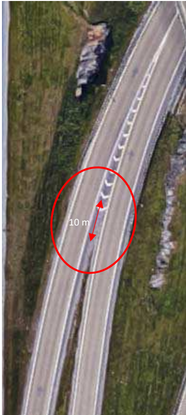
Kuva 11g ja 11h. Ramppi liittyy toiseen ramppiin: Kahden rampin yhdistyessä yhdeksi rampiksi ne kuvataan yhtenä geometriana. Ramppien yhdistäminen tehdään 10 metrin päässä fyysisestä jakajasta. Rampin jakaantuessa kahdeksi rampiksi ne kuvataan yhtenä geometriana, kunnes erotetaan kahdeksi geometriaksi 10 metrin päässä fyysisestä jakajasta
