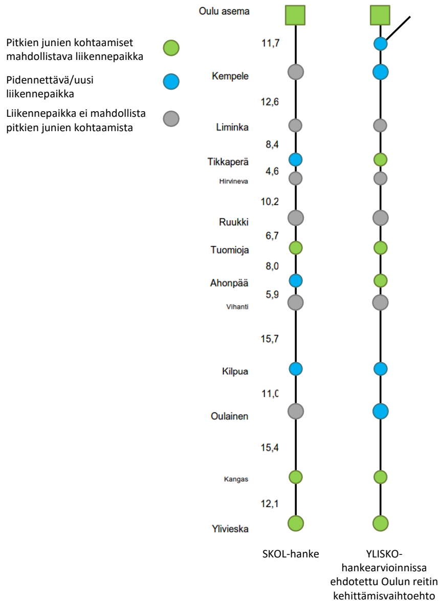
Kuva 19. Pitkät liikennepaikat Ylivieska–Oulu-välillä SKOL-hankkeen valmistuttua sekä YLISKO-hankearvioinnin Oulun reitin kehittämissvaihtoehdossa esitetyt toimenpiteet. Oulun reitin kehittämissvaihtoehtoon sisältyivät myös Oulun kolmioraide ja liikennepaikkamuutokset Oulu–Kontiomäki–Vartius-yhteysvälillä.
