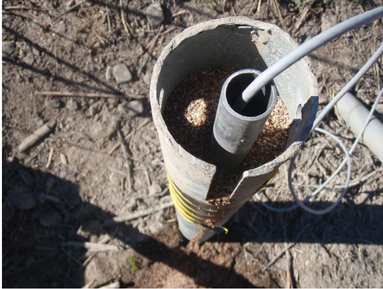
Kuva 9. FinMeasin inklinometri asennushetkellä tämän tutkimuksen kohteessa km 233+900.
