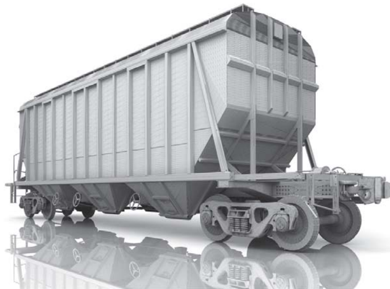
Kuva 7. Hopper Model 19-9870-01. Mittauksissa käytetty venäläinen vaunu. (Tikhvin Freight Car Building Plant)
