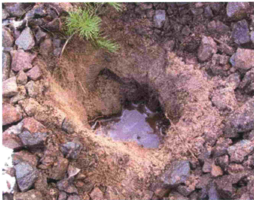
Kuva 4.7. Kosteuspitoisuudessa havaittiin suuriakin eroja. Oulainen–Kilpua-välin näytteenottoaikalla vettä kertyi näytteenottokuopan pohjalle noin 100 mm pohjan ollessa tasolla kv-850 mm.
