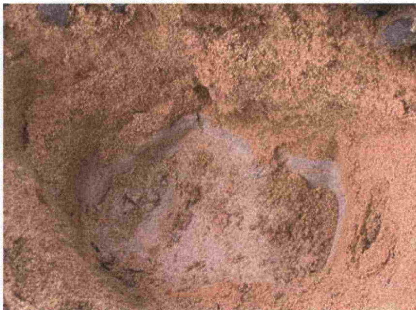
Kuva 4.5. Hienorakeisempaa ainesta karkeamman alla alusrakenteessa näytteenottoaikalla Kruunupyy–Kokkola-välillä.
