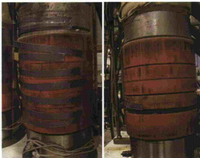
Kuva 5.3. Kaksi näytettä routanousukokeen jälkeen. Vasemmalla routimaton näyte ja oikealla routinut näyte.
