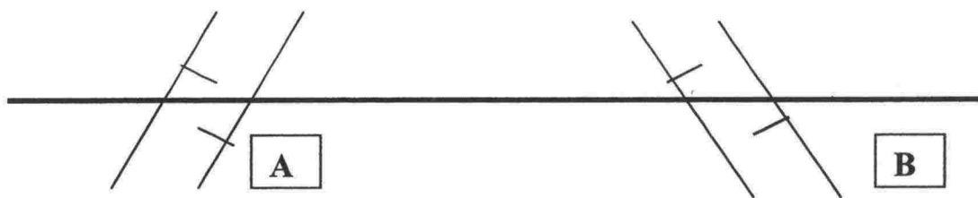
Kuva 21. Puomien välisen etäisyyden muuttuminen risteyskulman muuttuessa.
