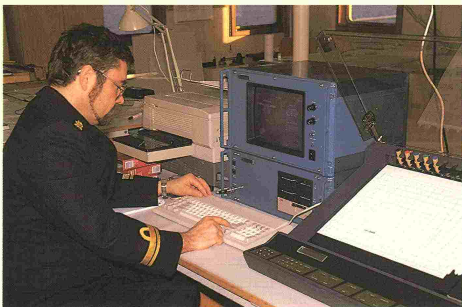
Merenmittaustukialus Prisman piirustussalin atk-laitteistoa. Vasemmalta piirturi, tietokone näyttöpäätteinen ja laser-kirjoitin.
