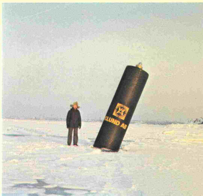
Esijännittämällä ankkuroitu muoviputkipoiju
