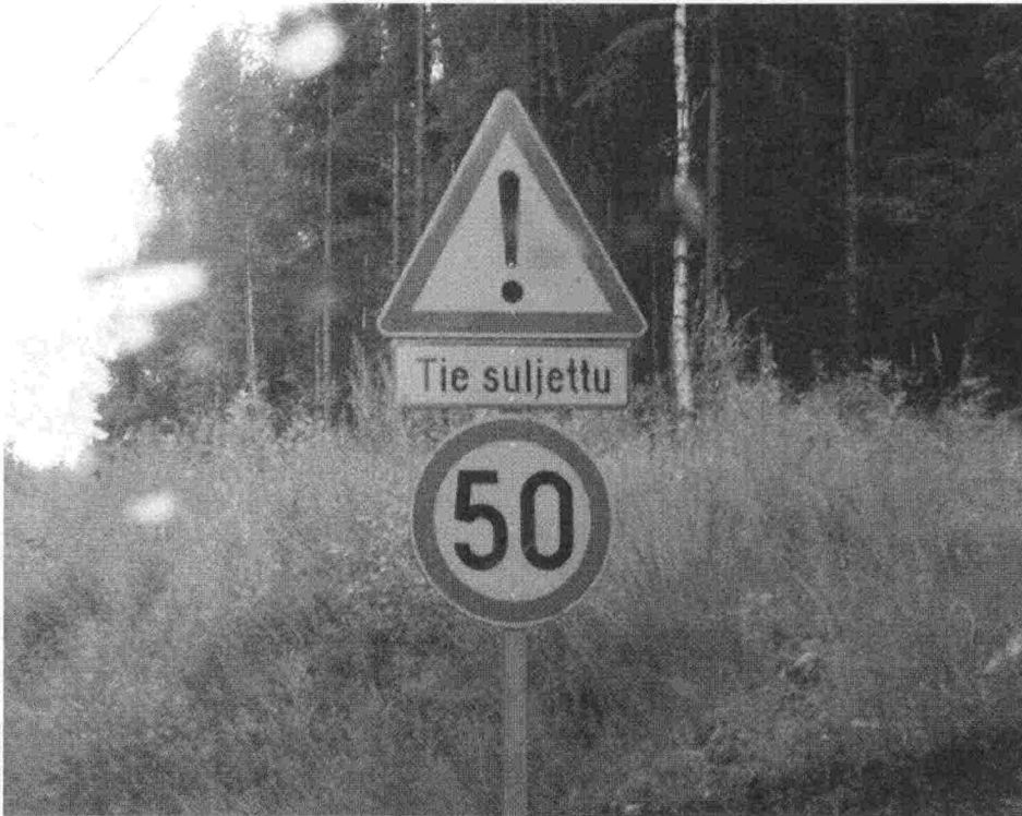
Kuva 12. Tie on suljettu. Nopeusrajoitus sallii vielä 50 km/h:n nopeuden, koska varoitusmerkki on aina asennettava 150-250 m etäisyydelle varoitettavasta kohteesta.
