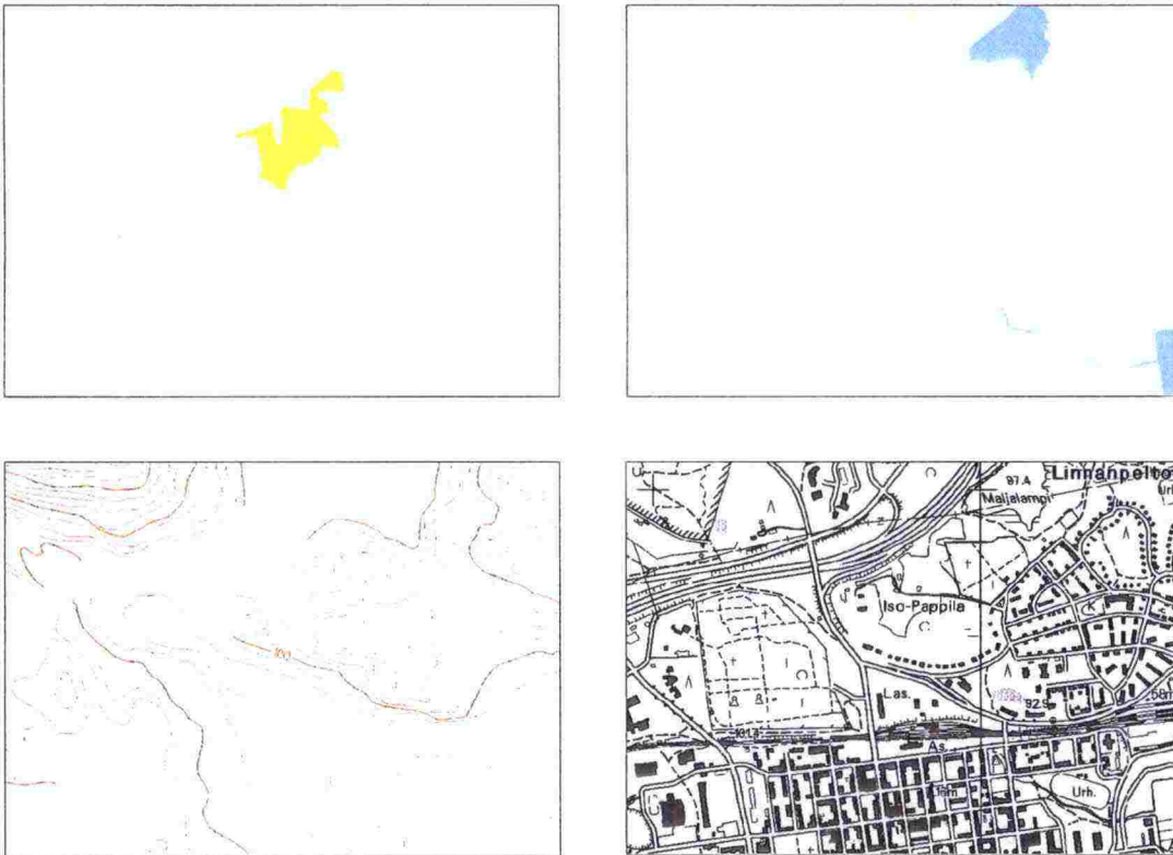
Kuva 7. Maanmittauslaitoksen tuottaman rasterimuotoisen peruskartan elementit vasemmalta ylhäältä lähtien: peltorasteri, vesistörasteri, korkeuskäyrärasteri sekä pohjarasteri.
