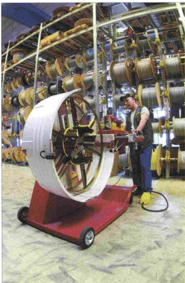
Libri Logistiikka Oy:n Sahanmäen logistiikkakeskuksen kaapelivarasto. Kuvassa automaatilla siirretään isolta kelalta kaapelia pienemmälle kelalle tilauksen mukaan.
