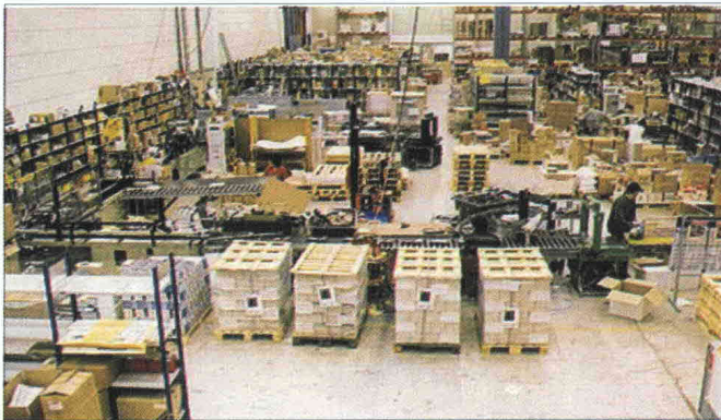
Libri Logistiikka Oy:n Hyvinkään Hakakallion logistiikkakeskus. Kuvassa on Levimatic-pakkaus-kone, jolla pakataan pääasiassa kirjoja ja muita massalähetyksiä miniaaltopahviin.
