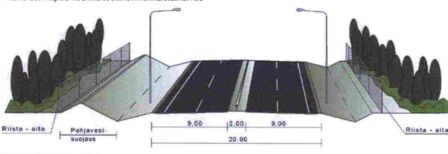
Kuva 28. Kapea keskikaiteellinen nelikaistainen tie
