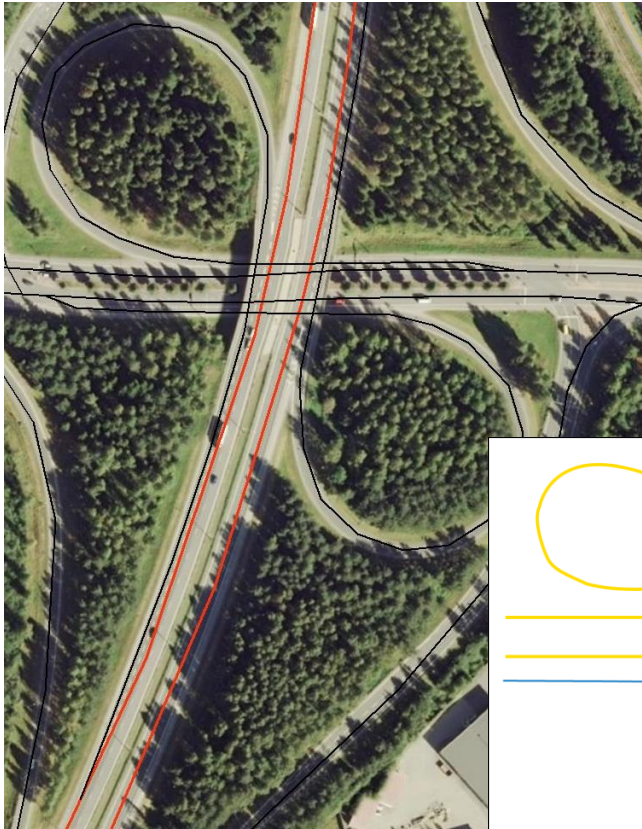
Kuva 11b. Silmukkaramppi: Silmukkarampit tallennetaan kuten muutkin rampit
