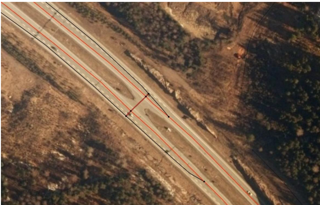
Kuva 23a. Mikäli huoltoaukkoa voidaan käyttää vastakkaisen ajosuunnan ramppiin liittymiseen (erikoiskuljetuksen tapauksissa), solmutetaan huoltoaukko sekä pääväylään että ramppiin.
