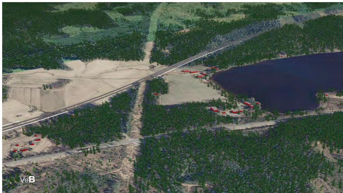
Kuva 8-23. Havainnekuva tielinjauksista Iso-Hirvanen -järven pohjoispuolelta vaihtoehdossa VE B. Kuvakulma luoteesta kaakkoon. Vaihtoehdon B silta näkyy kuvassa keskellä. Melusteiden sijainti on esitetty valkealla viivalla.
