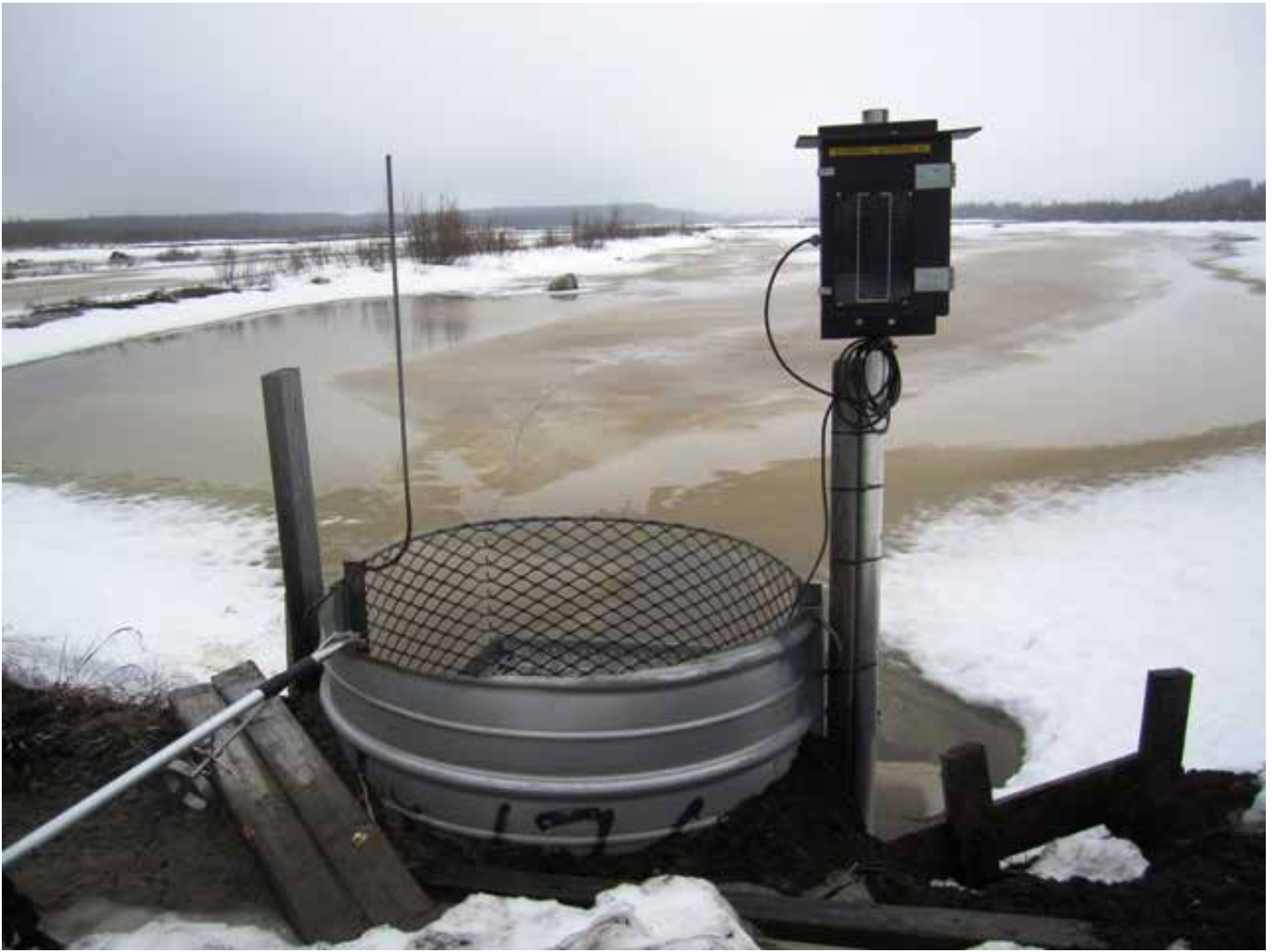
Kuva 10. Savonnevan kosteikolta lähtevän veden jatkuvatoiminen virtaamanmittaus oli toiminnassa heti lumien sulaessa keväällä 2013.
