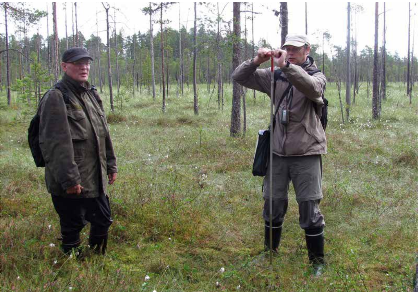
Kuva 5. Valuma-aluekartoituksissa pyrittiin selvittämään valuma-alueelta tulevan veden laatuun vaikuttavat tekijät. Suoalueilta selvitettiin mm. turvekerroksen paksuus ja maatuneisuus. Kuvassa ympäristögeologi Pekka Pulkkinen ja suunnittelija Jussi Helin kairaamassa turvenäytteitä Saarijärvellä Mustospuron valuma-alueella.
