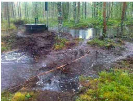
Kuva 9. Tulva-aikoina mittakaivojen kapasiteetti ylittyi useilla seuranta kohteilla. Kuvissa tulvien aikaisia mittausasemat ohittavia virtauksia metsätalousalueella (Soidinräme 1) ja turvetuotantoalueella (Savonneva).
