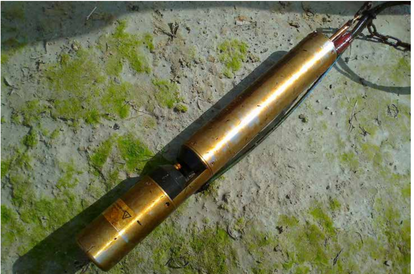
Kuva 8. Kairinevan humusaineita (COD ja DOC) mittaava automaattinen Props-anturi ennen manuaalista puhdistusta. Mittaikkuna sijaitsee anturin keskellä olevassa aukossa.
