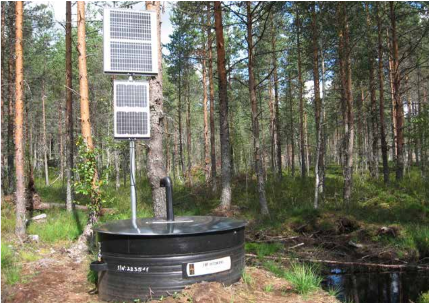
Kuva 2. TASO-hankkeen jatkuvatoiminen veden laadun mittausasema Kyyjärven kunnostusojituskohteella. Asemat saivat virran aurinkopaneeleista.
