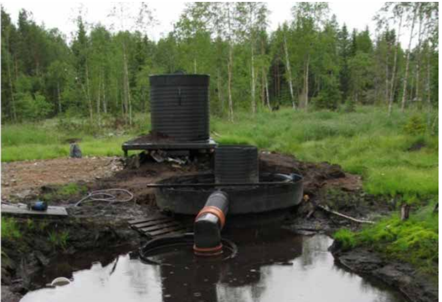
Kuva 30. TASO-hankkeessa Piuharjunnevan turvetuotantoalueella koekäytetty ferrisulfaattiannostelijan (takana) ja pystylaskeutusaltaan (keskellä) yhdistelmä. Etualalla annostelijan ja pystylaskeutusaltaan jälkeinen pieni laskeutusallas ja maa-allas. Taka-alalla ojitettu pintavalutuskenttä jonka toimintaa pienkemikaloinnilla pyrittiin tehostamaan.
