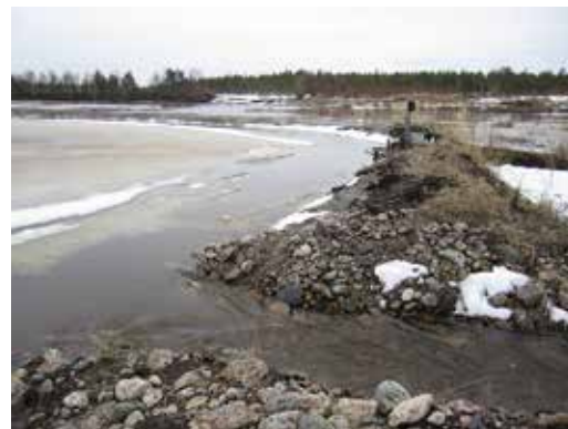
Kuva 9. Tulva-aikoina mittakaivojen kapasiteetti ylittyi useilla seuranta kohteilla. Kuvissa tulvien aikaisia mittausasemat ohittavia virtauksia metsätalousalueella (Soidinräme 1) ja turvetuotantoalueella (Savonneva).
