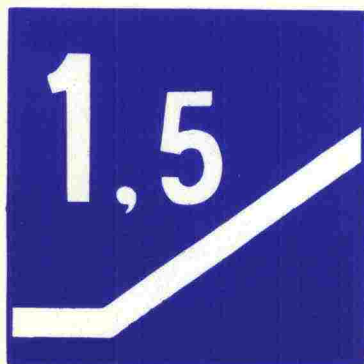
Kuva 14: Kanavaluiskan kaltevuus (kaltevuus vaakatasoon suhteen esim. 1:1, 1:2 tms, kuvassa 1:1,5)
