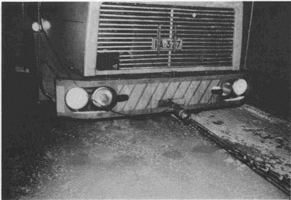
Kuva 22. Vetovoima mitattiin jarruautoon kiinnitetyllä venymäliuska-anturilla.
