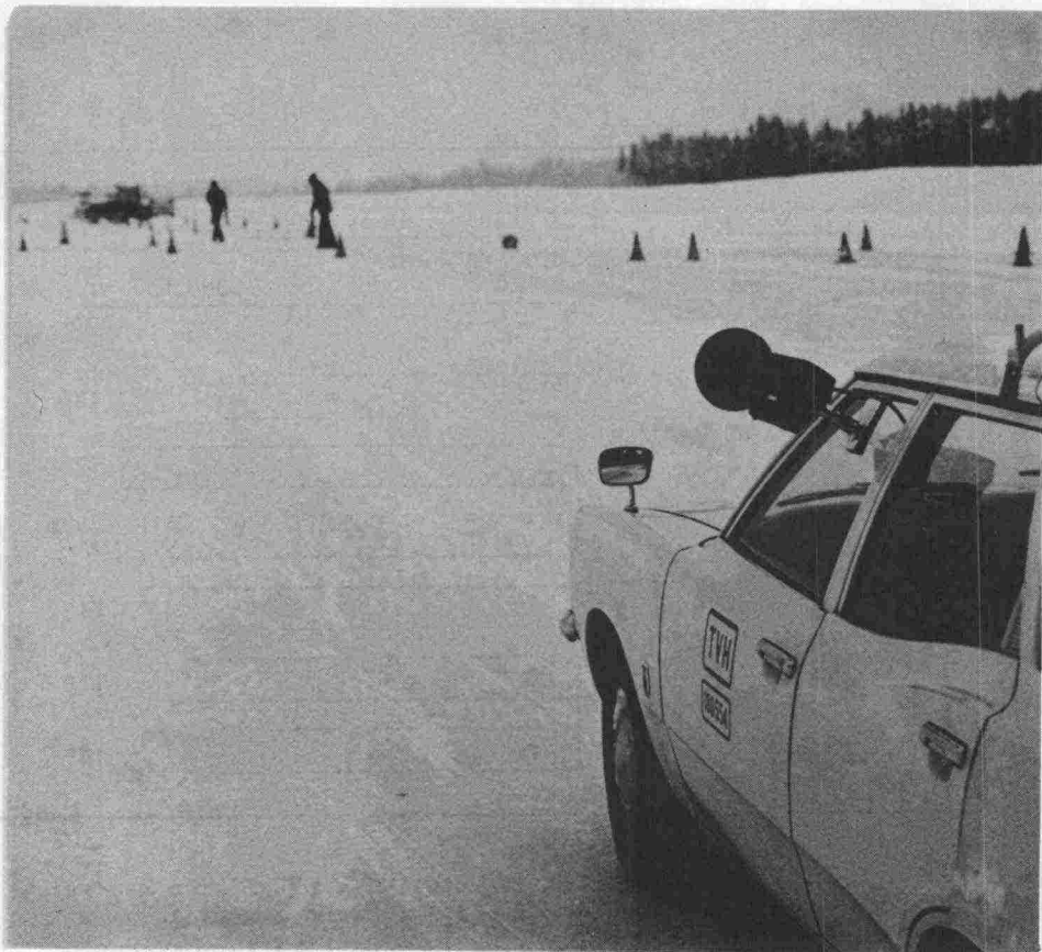
Kuva 15. Nopeuden mittaus suoritettiin kaikissa kokeissa liikennetutkalla.
