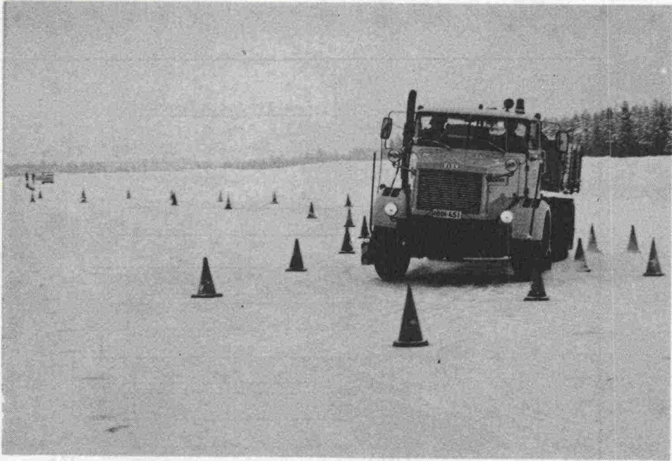
Kuva 14. Sisu-Kontio-auto vakiokaarrekokeessa. Kokeessa mitattiin nopeus, jolla ajoneuvo sortui ulos kartioilla merkitystä kaarteesta.
