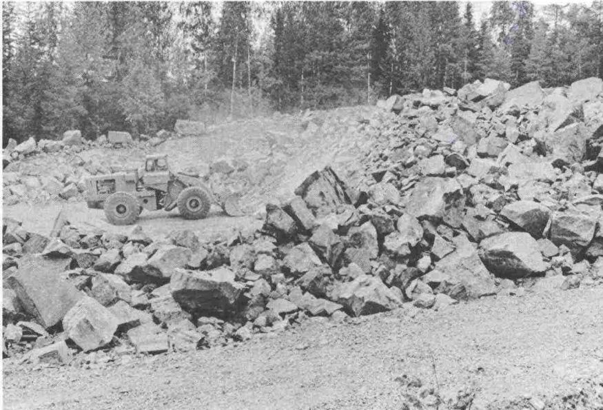
Kuva 4. Karkeaksi räjäytettyä louhetta (L3)
