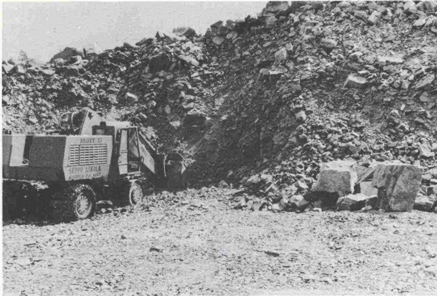
Kuva 5. Hienoksi räjäytettyä (L2), mutta paikalleen jäänyttä eli lukkoontunutta louhetta. Tutkimusten mukaan lukkoontunut, hienoksi räjäytetty louhe vastaa usein kuormattavuudeltaan karkeaksi räjäytettyä louhetta (L3)
