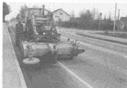
Kuva 13. Keräävää harjalaitetta voidaan käyttää paikoissa, missä ei löydy tilaa siirrettävälle hiekalle.
