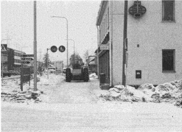
Kuva 3. Traktoriaura soveltuu hyvin kapeiden väylien auraukseen.
