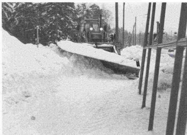
Kuva 2. Irtolumen paksuus ei saisi kevyen liikenteen väylillä ylittää 20...30 mm (nuoskalumi...pakkaslumi).
