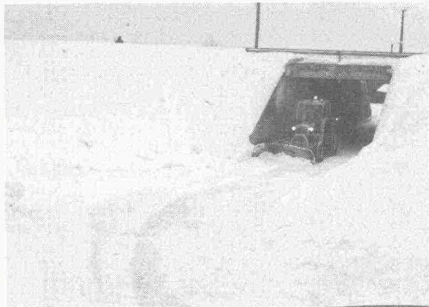
Kuva 5. Keveyen liikenteen väylien lumenpoistoon tulee valita sellainen kalusto, että alikulkukäytävien ja siltojen lumenpoisto voidaan suorittaa samalla kalustolla.
