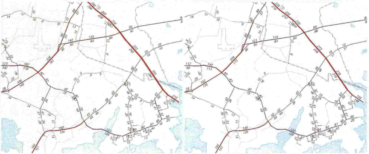
Kuva 19. Raskaan liikenteen määrät vuonna 2025 iltaruuhkatunnissa, kun junaliikenteen osuus sataman kuljetuksista on 11 % (vas, nykyinen osuus) ja 32 % (oik, tavoitteellinen osuus).
