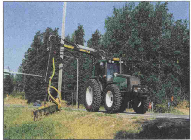
Kuva 118. Leikkuupää koneen takana puomistossa
