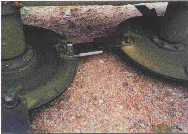
Kuva 106. Lautasniittokoneissa on kiinteät veitsiterät tai lautasiin nivelletyt terälaput
