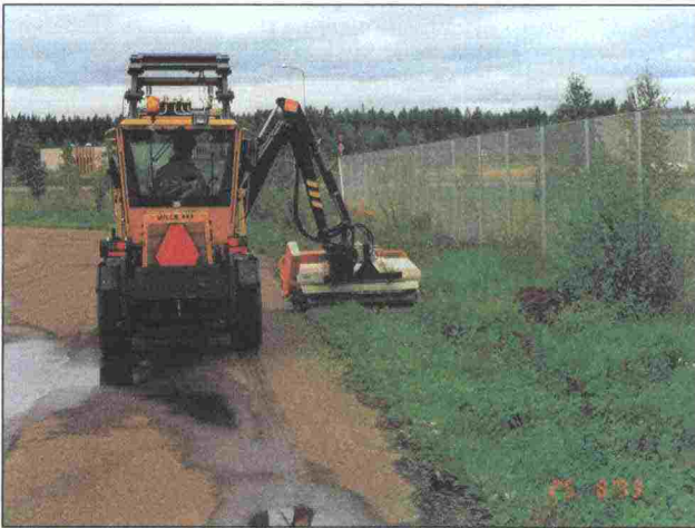
Kuva 111. Runko-ohjattu hydrostaattisella voimansiirrolla varustettu pyörätraktori ja Hitec 420 -kaivuri-puomisto. Leikkuupäänä Garroy Giraudon -kelasilppuri varustettuna Y-terillä
