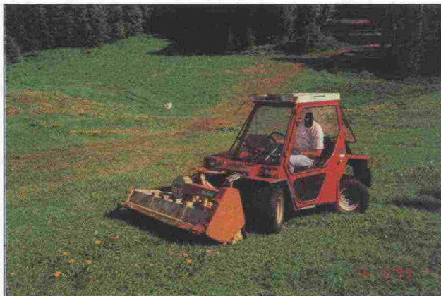
Kuva 123. Matalapainopistetraktori Bucher varustettuna Garroy Giraudon -kelasilppurilla
