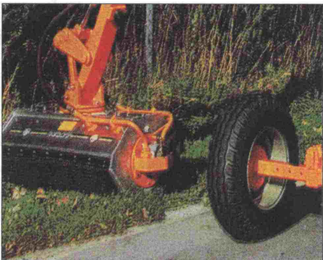
Kuva 120. Alumiininen kevytleikkuupää ja puomiston tuentapyörä
