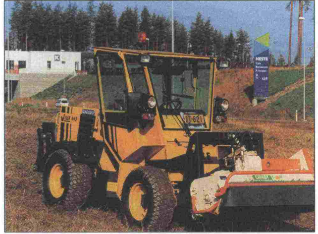
Kuva 124. Asiallisesti suojattu kelasilppuri ja varoitusviikulla varustettu peruskone
