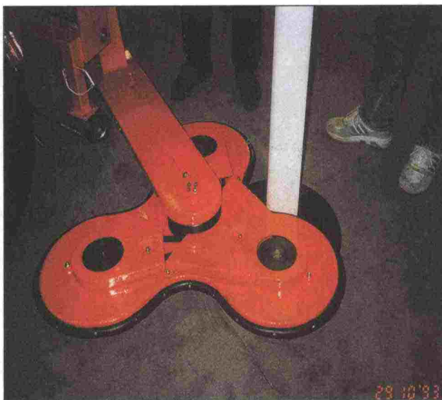
Kuva 107. Kohteen ympäri pyörähtävä veitsiterällä varustettu "kolmiapila"-leikkuupää
