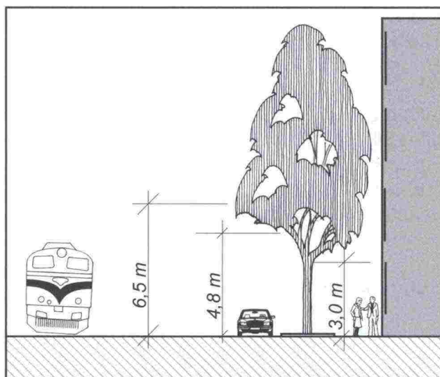
Katupuiden rungon vapaakorkeus
