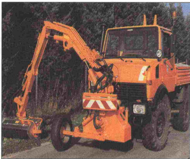
Kuva 119. Kevytkuorma-auto varustettuna etusovitteisella Berky 4800 -niittolaitteella, jossa ketjuverhottu kevytmetallinen kelasilppuri. Puomistossa on hydraulisesta painottuva tuentapyörä. Puomisto on kääntävissä 180 astetta tien toisen puolen niittoa varten
