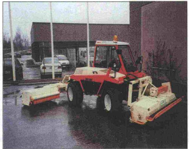
Kuva 125. Työkoneen leikkuupäiden kokonaistyöleveys on yhteensä kolme metriä
