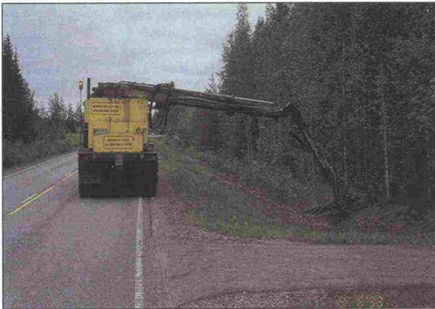
Kuva 108. Alustallaan pyörivän liukujatkeisen puomiston ulottuma on 10 - 14 m
