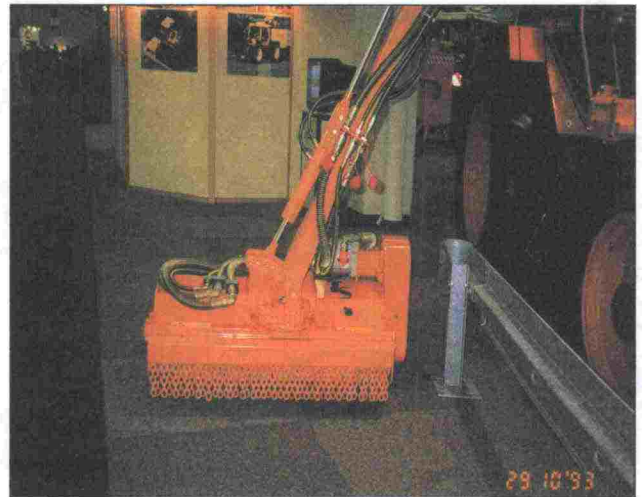
Kuva 103. Ketjuverhous on hyvä suoja sinkoilevia kiviä vastaan
