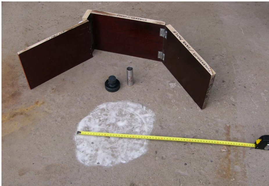
Kuva 3. Eristysalustan pinnan karkeuden (karheuden) mittausvälineet (Lasihelmet, lasihelmien mitta-astia, levitystyökalu, metrimitta, tuulensuojus).
