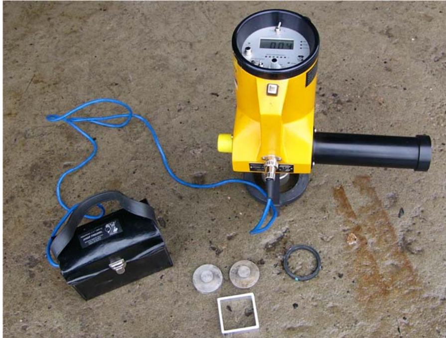
Kuva 5. Tartuntavetolaite Easy-M, akku, vetolaikkoja ja kermieristyksen tartuntavetokohdan reunojen leikkausohjaimia.
