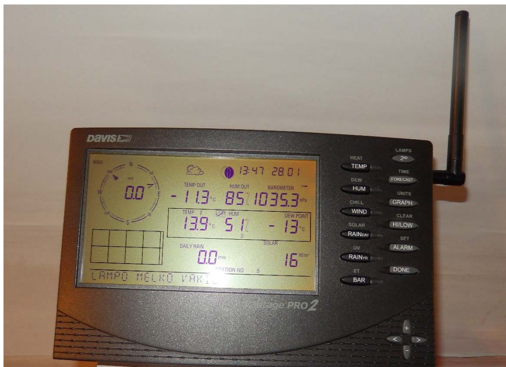
Kuva 4. Siirrettävän sääaseman jatkuvasti päivittyvä säähavaintotulosten näyttölaite.
