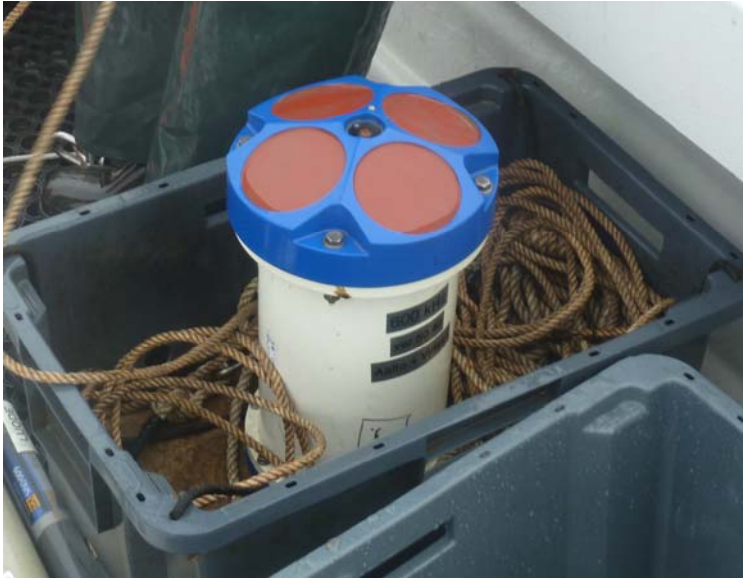
Kuva 9. Tutkimuksen virtausmittauksissa käytetty RD Instruments Sentinel workhorse -sarjan ADCP-mittari (kuva: Tiina Vaittinen).
