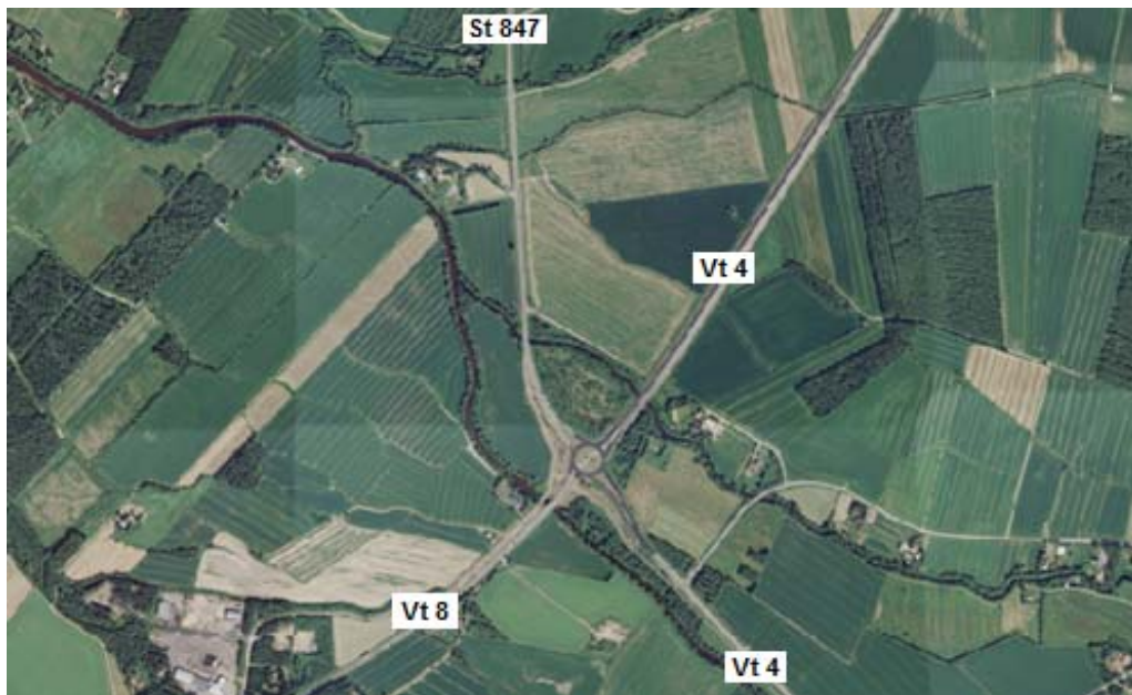
Kuva 20. Kaksikaistainen kiertoliittymä maaseutumaisessa ympäristössä Limingassa Pohjois-Pohjanmaalla. Kohteessa valtatie 4, valtatie 8 ja seututie 847 risteävät. Kiertoliittymää ympäröi jokaisessa suunnassa laajat peltoalueet. (Tiemappi 2015g.)
