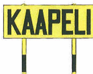
Kuva 33. Kaapeli- ja johtotaulu (kuvassa kaapelitaulu)
