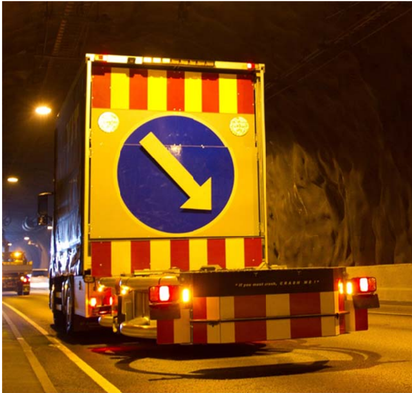
Kuva 13. Suoja-ajoneuvoon asennettu törmäysvaimennin (TMA).
